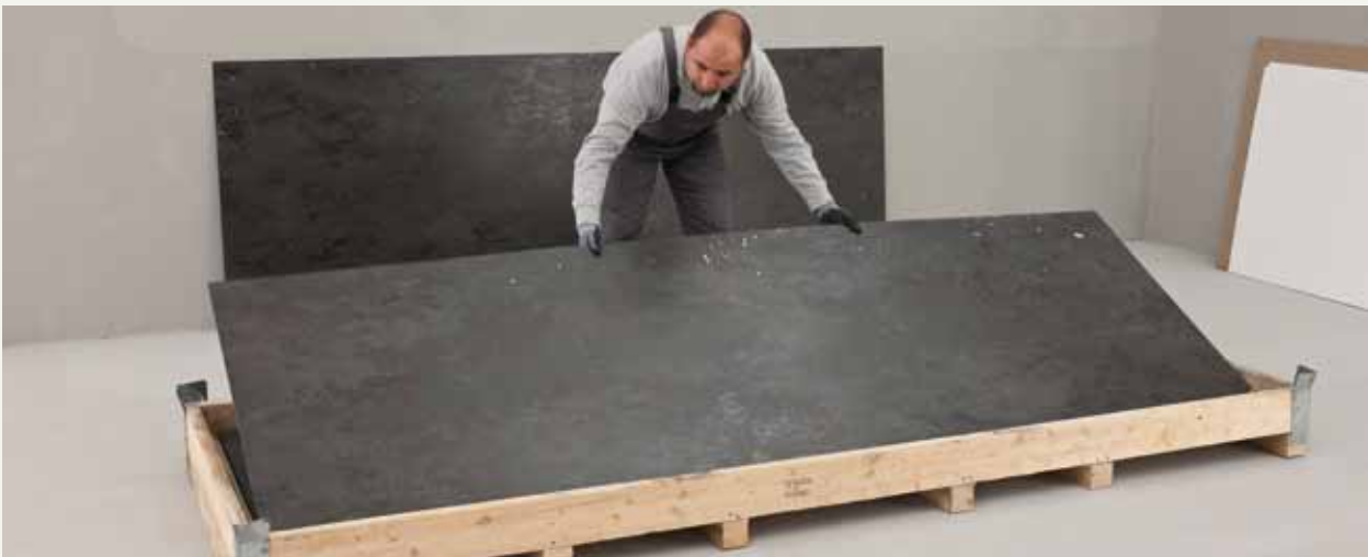
fig.8 / При хранении плит в горизонтальном положении, рекомендуем штабелировать несколько плит, удостоверившись в чистоте их поверхностей и абсолютной ровности опоры. Вы можете штабелировать максимум 50 плит Laminam 3.
