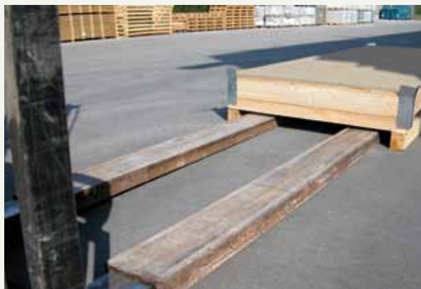
fig.4 / В случае захвата паллеты с короткой стороны или в случае перемещения поддона TWIN BED, что может случиться при разгрузке контейнера, для правильного перемещения плит необходимо использовать вилы длиной не менее 2,5 м.
